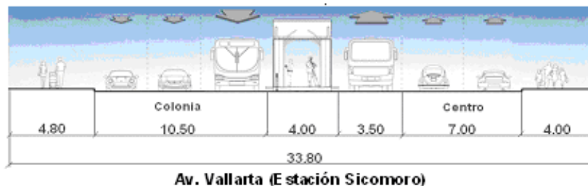
Figura 3-7. Sección tipo del corredor UTF
