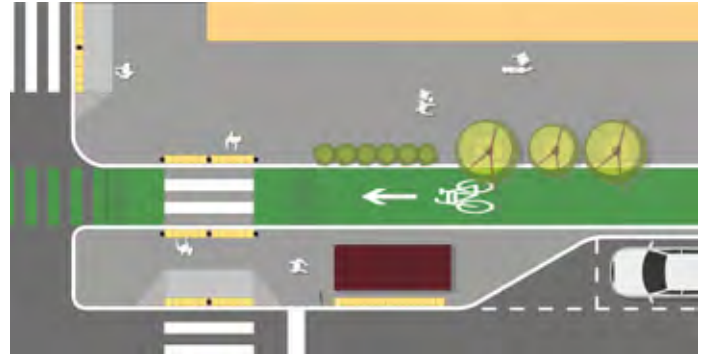
Ilustración FH 25 - 6 Planta. Parada adyacente a vía ciclista
