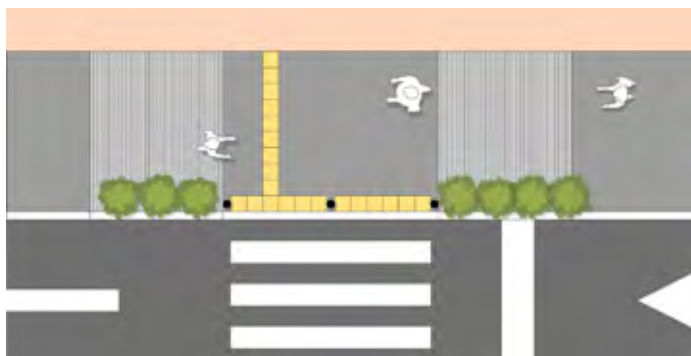
Ilustración FH 05 - 3 Planta. Rampa recta entre cuadra
