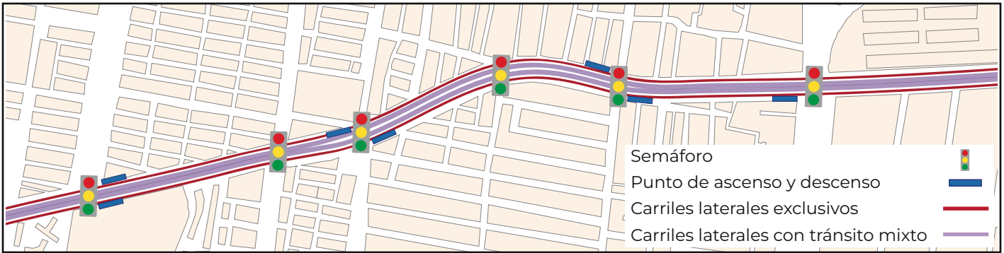
Ilustración SV 02 - 7 Planta. Proyecto de semaforización vehicular en corredor de autobuses con carriles en acera lateral
