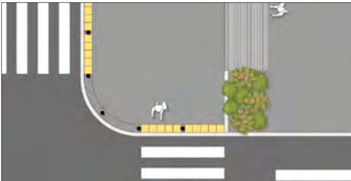
Ilustración FH 10 - 3 Planta. Franja de advertencia en cruce peatonal
