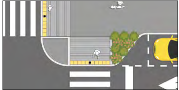
Ilustración FH 10 - 2 Planta. Franja de advertencia en cruce peatonal
